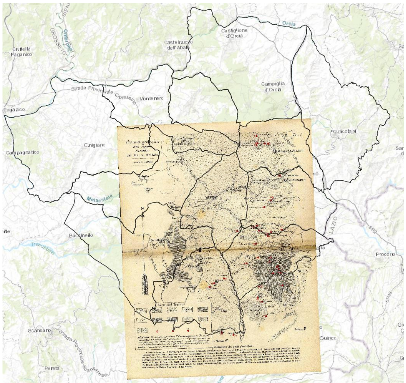
Figura n. 4 – Esempio di immagine correttamente georeferenzata; come si può osservare rispetto all'immagine in figura n. 3 le bande nere non vengono introdotte rendendo molto più gradevole la vista complessiva del raster.
