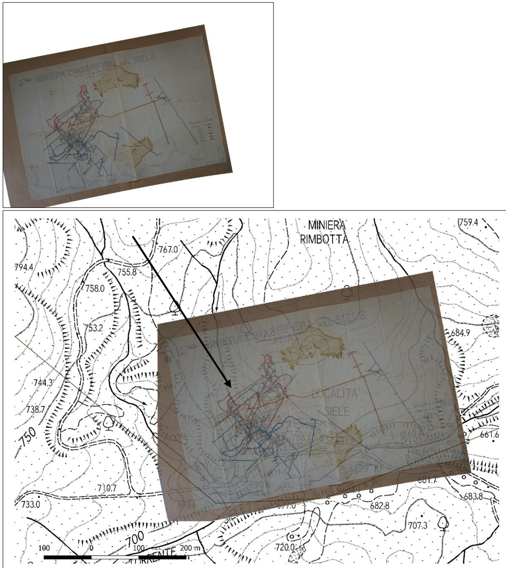
Fig. 17; Cartografia mineraria georiferita in ambiente GIS, esempio della Miniera del Siele. Combinazione di cartografie storiche: (carta 633, 1898; carta 624, 1905)
